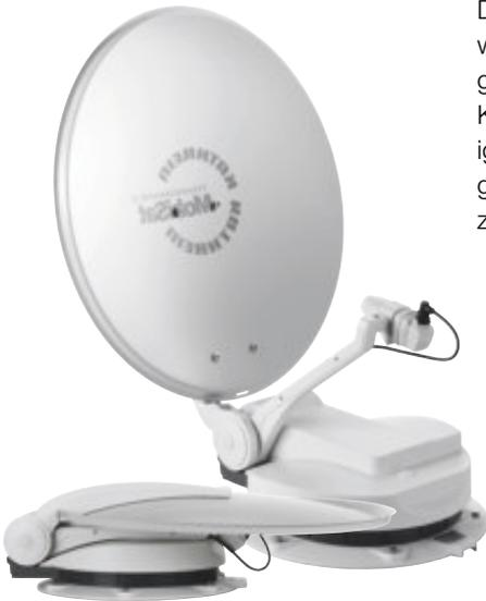
Da sie, je nach Standort des Fahrzeugs, rundum beweglich sein muss und bei allen Witterungsbedingungen zuverlässig funktionieren soll, kommt ein Kunststofflager aus dem Material iglidur® J von igus® zum Einsatz. Mit diesem Lager wurde im Vergleich zu Edelstahl auch eine Kosteneinsparung erzielt.
