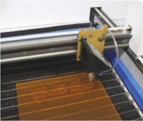
Die Achsen werden über Schrittmotoren verfahren, als Linearführungen kommen runde und eckige DryLin® W-Schienen zum Einsatz. Die Maschine läuft mit dieser Führung perfekt, es entsteht kein Stick-Slip, sodass igus®-Produkte den Vorzug vor herkömmlichen Rollenführungen bekommen haben.
