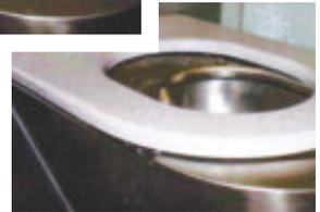
Beim Ausfahren wird der Sitz getrocknet. Die verwendete Linearführung soll stabil und beständig gegen Korrosion, Verschmutzungen sowie Reinigungschemikalien sein.
