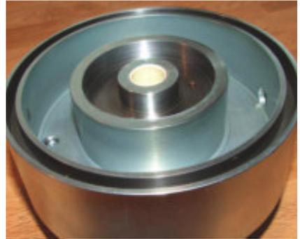
Hier kamen iglidur®-Gleitlager von igus® zum Einsatz, welche optimal für die Bewegungen mit niedrigem Hub und Frequenz bei gleichzeitig hoher Verschleißfestigkeit und geringem Reibwert geeignet sind.
