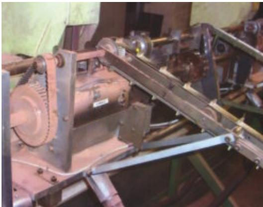
Durch den Einsatz von DryLin<sup>®</sup> R-Lineargleitlagern und Flanschlagern aus iglidur<sup>®</sup> G spielt die Staubbelastung keine Rolle mehr, denn an den schmierfreien Lagern bleibt kein Staub haften.
