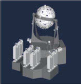
Die Projektoren in einem Planetarium sollen nicht in den Zuschauerraum projizieren, um Blendungen der Zuschauer zu vermeiden. Zu diesem Zweck werden Blenden eingesetzt, die sich abhängig von der Lage des jeweiligen Projektors selbstständig ausrichten.
