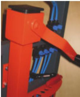
Hier kommen Flanschlager aus iglidur®G zum Einsatz. Weiterhin sind im Gerät igubal®-Axiallager SAM zur Führung der Trapezspindeln und im Fahrwerk Polysorb-Tellerfedern von igus® verbaut.
