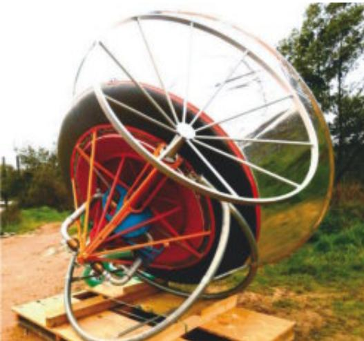
Acht verschiedene igus®-Gleitlager aus den Materialien iglidur® G, M250 und dem hochoberflächenbeständigen iglidur® X sind in der Pumpe verbaut und realisieren die verschiedenen Schwenk- und Linearbewegungen langlebig und kostengünstig.
