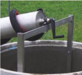
Zudem ist die Lagerstelle der Witterung ausgesetzt. Die Lagerung besteht aus einem Festlager und einem Loslager. Das Gewicht des kompletten Rotors beträgt rund 100 Kilogramm. Hier wurden zwei igubal®-Stehlager KSTM verwendet.
