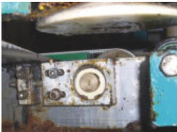
Ein anderes Lagerteil, das kurz vor dem Ausfall stand, ersetzen die Konstrukteure durch ein aus einem iglidur®-Halbzeug selbst gedrehtes Lager. Auch dieses Teil musste seitdem nicht mehr ausgewechselt werden.
