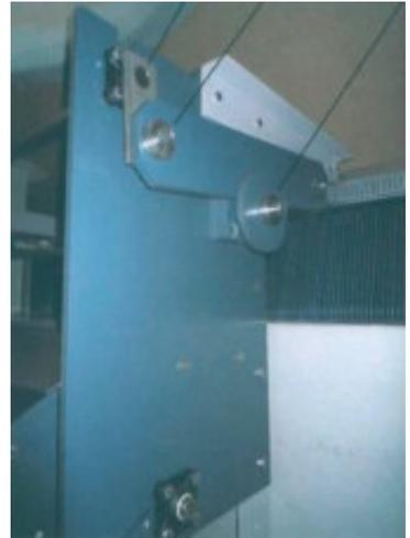
Bei beiden Produkten müssen die verwendeten Materialien absolut chemikalien- und korrosionsbeständig sein, zudem sollen sie wartungsfrei sein. Verschiedene igus®-Lager aus dem gesamten Gleitlager-Sortiment kommen hierbei zum Einsatz.
