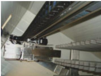
Verschiedene igus®-Produkte wie die DryLin® ZLW-Zahnriemenachse, aber auch diverse iglidur® Flanschlager sowie DryLin® N- und DryLin® T-Linearführungen sind hier verbaut und sorgen mit für das gewünschte Geschmackserlebnis.
