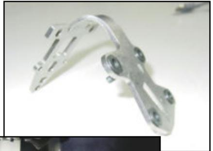
Mit der Verwendung von iglidur®-Clipslagern von igus® konnte der Mechanismus verbessert werden. Ihre Vorteile sind die gleichbleibende Bundstärke und die hohe Verschleißfestigkeit bei verschiedenen Umgebungsbedingungen wie Kälte, Hitze oder feinem Saharasaand.
