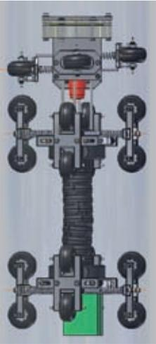
Dieser Inspektionsroboter wurde speziell für den Einsatz in Pipelines entwickelt. Er kann sich schraubenartig bewegen. So macht er alle Richtungsänderungen mit, egal ob es in die Höhe oder in die Tiefe geht. Die Räder werden der Bewegung entsprechend pneumatisch an die Innenwände der Pipeline angepresst. Zum Einsatz kommen hier igus®-Produkte aus verschiedenen Kategorien: iglidur®- und igubal®-Lager sowie die Energiekette Triflex® R.
