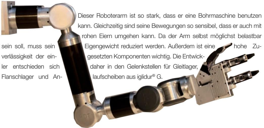
Dieser Roboterarm ist so stark, dass er eine Bohrmaschine benutzen kann. Gleichzeitig sind seine Bewegungen so sensibel, dass er auch mit rohen Eiern umgehen kann. Da der Arm selbst möglichst belastbar sein soll, muss sein Eigengewicht reduziert werden. Außerdem ist eine hohe Zuverlässigkeit der eingesetzten Komponenten wichtig. Die Entwickler entschieden sich für Flanschlager und Anlaufscheiben aus iglidur® G.
