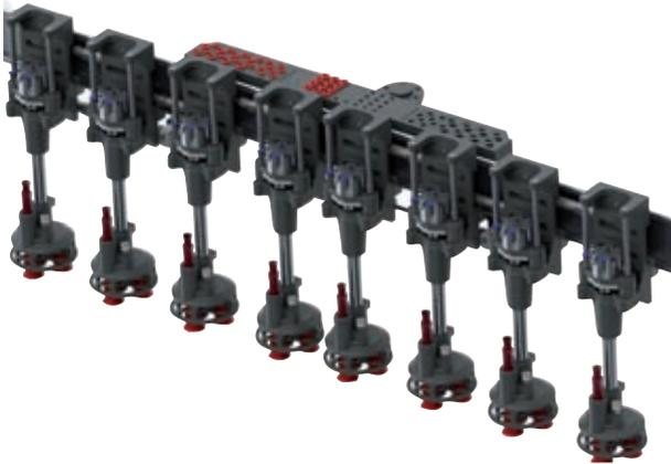
Dieser Greifer nimmt Verpackungseinheiten aus einer Versiegelungsmaschine, dreht die einzelnen Einheiten um 90 Grad und verteilt Sie auf Kartons. Der Greifer arbeitet dabei mit Hilfe von Vakuumsaugern. Die verwendeten Komponenten sollten zum einen möglichst wenig Verschleiß aufweisen, zum anderen auch leicht und schmiermittelfrei sein. Zum Einsatz kommt daher eine DryLin® W-Profilführung.
