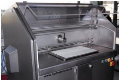
Gerade im Umgang mit Lebensmitteln kommt es auf höchste hygienische Sorgfalt an. Diese Maschine schneidet Lebensmittel aller Art in beliebige Stücke oder Muster. Dabei können die Lebensmittel sogar noch gefroren sein. igus® DryLin®-Lineargleitlager in Kombination mit Edelstahlwellen sorgen für eine einfache Reinigung der Maschine. Die Schmiermittelfreiheit verhindert jegliche Produktkontamination.
