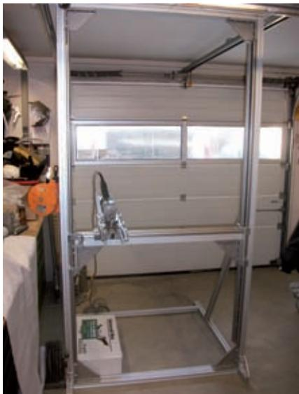
Diese Rahmenkonstruktion erlaubt es dem Anwender, die eingespannten Werkzeuge wie zum Beispiel Schweiß- oder Fräsgeräte beliebig auf drei Achsen zu verfahren. So kann der körperliche Kraftaufwand erheblich reduziert und die Handhabung der Werkzeuge deutlich vereinfacht werden. Dadurch erhöht sich die auch die Arbeitssicherheit. Es wurden in allen drei Achsen DryLin® W-Doppelschienensysteme verbaut.
