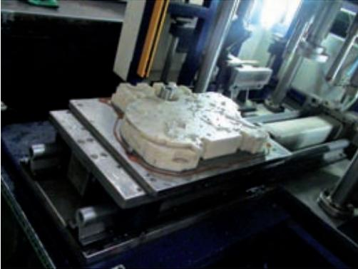
In dieser Anlage werden Aluminium-Gussformen auf ihre Dichtigkeit überprüft. Dazu muss der Bediener nur die zu prüfende Form auf der Arbeitsfläche ablegen. Die Arbeitsfläche verfährt dann in die Anlage, in der die Form geprüft wird. Hier kommt auch Wasser zum Einsatz, weshalb die Linearführung unter Wasser ebenfalls zuverlässig arbeiten muss. Die Konstrukteure entschieden sich daher für eine schmierfreie DryLin® R-Linearführung.
