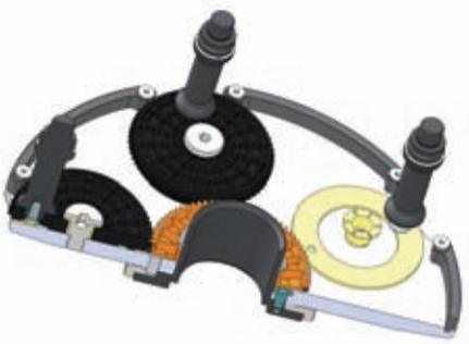
Diese variablen Typenspannplatten dienen dazu, ein Fahrzeugrad an einer Radauswuchtmaschine aufzunehmen. Bei der Neukonstruktion kamen igus®-Anlaufscheiben und Flanschlager zum Einsatz. Sie machten die aufwändige Fräsbearbeitung der Grundplatte überflüssig und die Bauhöhe konnte um acht Millimeter reduziert werden. Die Hutmutter zur Spieleinstellung konnten durch die spielfrei vorgespannten iglidur® JVFM-Lager ebenfalls eingespart werden.
