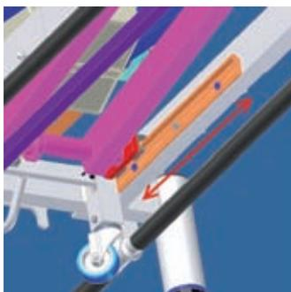
Auch dieser elektrisch verstellbare Untersuchungstisch wurde zum manus®-Wettbewerb eingereicht. Bei der Überarbeitung der Konstruktion wurden Rollensysteme durch ein DryLin® W-Schienensystem von igus® ersetzt. Während die Rollen klemmten, verschleißanfällig waren und zu viel Spiel aufwiesen, erfüllen die igus®-Produkte alle Anforderungen an eine leichte und einfache Benutzung und Montage.
