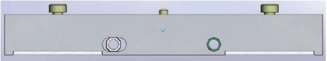
Mit dieser Maschine werden Produkte in Blisterfolie verpackt. Durch eine Neukonstruktion sollte die Taktleistung erhöht werden. Im Rahmen der Neukonstruktion wurden die Leisten, die die Paletten mit der Transportkette verbinden, geändert; dazu musste ein neues Lager entwickelt werden. Das neue Lager lässt einen axialen Versatz sowie eine Rotationsbewegung zu. Es wurden Standard iglidur®-Gleitlager sowie ein igus®-Sonderlager verbaut.
