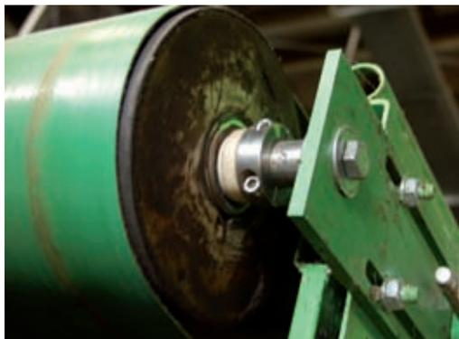
Diese Anlage dient der Aufbereitung und Trocknung von Küchenkräutern. Bislang sorgten verschmutzte und nicht funktionierende Bandabstreifer, defekte Kugellager und verschlissene Wellenstummel von Bandwalzen für Ausfälle. Mit Sonderteilen aus iglidur® für die Bandabstreifer und regulären iglidur®-Gleitlagern als Kugellagersersatz konnten die Ausfallzeiten deutlich reduziert werden.
