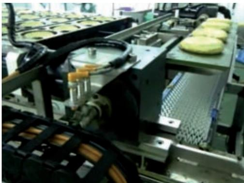
Da die Tortillas von beiden Seiten gebraten werden müssen, ist eine Drehung erforderlich. Mit Hilfe von pneumatischen Zylindern werden die Omeletts gestürzt. Auch diese Bewegung wird mit igus®-Produkten geführt. Diese Aufgabe übernehmen zwei DryLin® OGA-Lineargehäuse auf einer unterstützten Edelstahlwelle. Diese Lösung eliminiert Ausrichtungsfehler.
