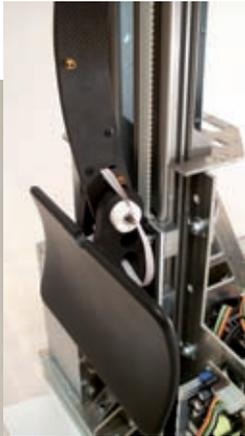
Mit diesem Gerät können Skispringer ihre Sprünge verbessern. Das Gerät ist dabei nur 23 Kilogramm schwer und lässt sich schnell und einfach auseinander- oder zusammenbauen. Zur Gewichtsreduzierung tragen nicht zuletzt die verwendeten Bauteile von igus® bei. Die vertikale Bewegung wird mit einer DryLin® ZLW-Zahnriemenachse geführt. Das Drehgelenk nutzt ein Hybridlager für die radialen Lasten sowie iglidur® Gleitlager für die axialen Lasten.
