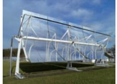
Auch bei diesem solarthermischen Kraftwerk wird aus den Strahlen der Sonne - und damit ohne fossile Brennstoffe - Energie gewonnen. Die Parabolspiegel sind mit Kunststoffgleitlagern von igus® ausgerüstet, die eine hohe Lebensdauer aufweisen und eine Wartung überflüssig machen. Zum Einsatz kommt hier ein für diese Anwendung neu entwickeltes Lager, das in der Herstellung wesentlich günstiger ist als ein vergleichbares Wälzlager.
