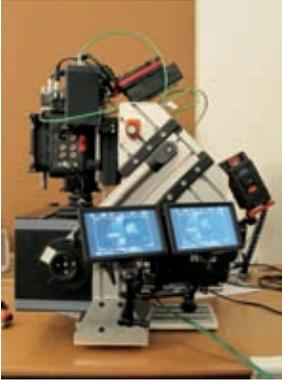
Bei diesem 3D-Kamerasystem „3D RIG“ wurde Wert auf die möglichst leichte Verstellung und Wartungsfreiheit gelegt. Metallische Kugellager schießen daher wegen ihres Gewichts aus, außerdem waren sie anfällig für Korrosion und benötigten Schmiermittel. DryLin® SLW-Kreuztische und DryLin® W-Linearführungen sorgen dafür, dass die beiden Kameras exakt gleich verstellt werden können. Das ist wichtig, da nur so das dreidimensionale Bild entstehen kann.
