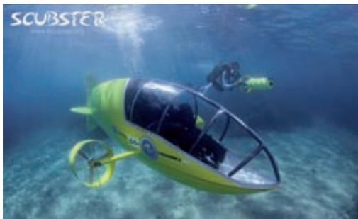
Meerwasser ist wegen seines hohen Salzgehalts eine sehr korrosive Umgebung. Bauteile, die dem Wasser ausgesetzt sind, müssen ihm standhalten. Die in diesem U-Boot eingesetzten xiros®-Polymerkugellager mit Glaskugeln führen die Propellerachsen sowie die Lenkungs- und Kuppelantriebe. Die xiros®-Lager von igus® sind gegen die chemischen Reaktionen im Salzwasser unempfindlich.
