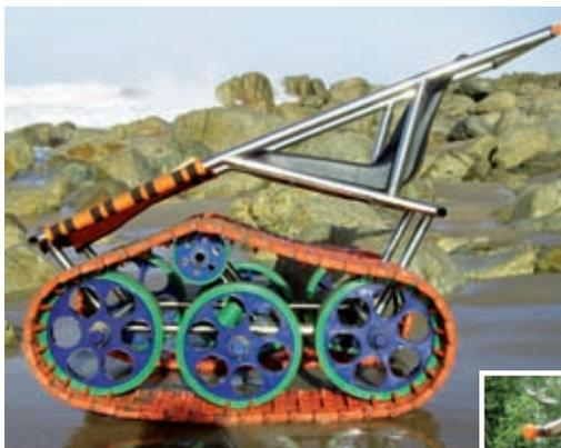
Dieser spezielle Rollstuhl ermöglicht Gehbehinderten den Strandbesuch. Dazu wurde er statt mit Rädern, mit Ketten aus Kunststoff konstruiert. Die Achsen sind mit iglidur®-Buchsen gelagert. Vorher eingesetzte Kugellager hielten den aggressiven Bedingungen mit Sand und Salzwasser nicht eine Woche stand. Die iglidur®-Buchsen versehen dagegen störungsfrei ihren Dienst.
