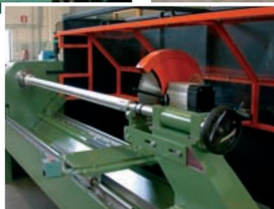
Diese Säge schneidet auf Spulen gewickelte Plastikfolien. Das Sägeblatt kann auf der gesamten Spulenlänge verfahren werden und sich in die Folie reinsägen. Die Bewegungen dieser beiden Achsen werden mit unterstützten Wellen und Wellenführungen aus dem DryLin® R-Sortiment geführt. Wichtig war hier die präzise Positionierung für saubere Schnitte sowie die Wartungsfreiheit der gesamten Anlage.
