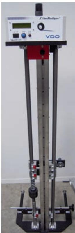
Dieses Gerät kann den Umfang von Autoreifen vermessen, ohne dass das Fahrzeug bewegt werden muss. So kann flexibel an jeder beliebigen Stelle gemessen werden, es ist kein Teststand erforderlich. Das Gerät berücksichtigt bei der Messung auch die Verformung des Reifens durch das Fahrzeuggewicht. Es kommen mehrere verschiedene igus® DryLin®-Produkte zum Einsatz: Miniaturlinearführungen DryLin® N, Flanschwellenböcke, Aluminiumwellen und Flanschgehäuse.
