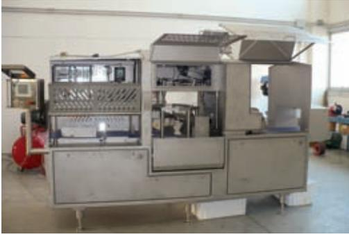
Auch in dieser Maschine werden Lebensmittel verarbeitet, hier roher Schinken. Damit das Fleisch nicht mit Schmiermitteln verunreinigt wird, wurden schmiermittelfreie Gleitlager von igus® verbaut. Zum Einsatz kommen Lager aus iglidur® G und iglidur® J. Sie sind beständig gegen die Reinigungsmittel, mit denen die Maschine regelmäßig gesäubert wird.
