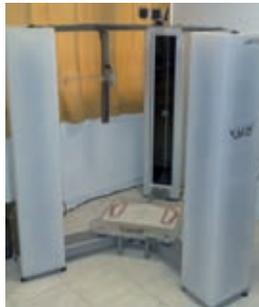
In diesem medizinischen Körperscanner kommt ein DryLin® T-Linearführungssystem zum Einsatz. Ausschlaggebend für das igus®-Produkt waren seine kompakte Bauweise sowie die Möglichkeit, Friktion und Spiel einstellen zu können. Weitere Vorteile sind die Wartungs- und Schmiermittelfreiheit und die damit verbundenen geringeren Kosten.
