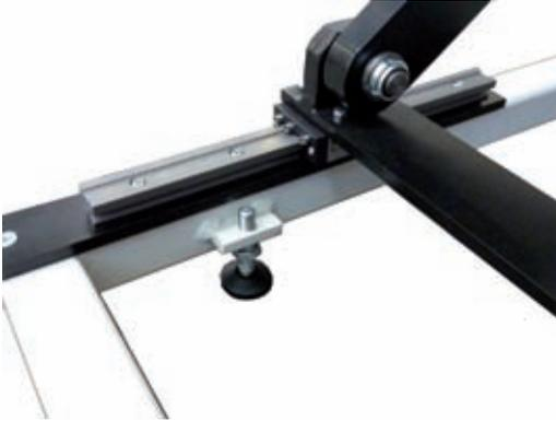
Auch in dieser Anwendung wurden metallische Kugellager durch eine igus®-Lösung ersetzt. Geräuschfrei und präzise sorgen hier DryLin® T-Schielenführungen mit einstellbarem Spiel für die Höhenverstellung der Arbeitstische. Mit den Arbeitstischen können große zu verarbeitende Werkstücke an beiden Seiten der Maschinen positioniert werden. Die Tische werden dann auf die Arbeitshöhe der jeweiligen Maschine eingestellt.
