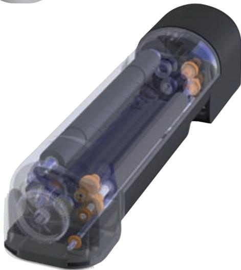
In diesem Gerät werden Briefe gefaltet. Der Falzvorgang auf kleinstem Raum reduziert die Baugrößen von Falzmaschinen je nach Einsatzgebiet bis auf ein Zehntel der herkömmlichen Technik. Um das umzusetzen, waren spezielle Lösungen nötig, die die technischen Anforderungen wie die Vermeidung von Schmierfetten im Papier-Vorlaufbereich, Geräuschminimierung oder Gewichtsreduktion erfüllen. Zum Einsatz kommen daher Kunststoffgleitlager aus den Werkstoffen iglidur® G und iglidur® J.
