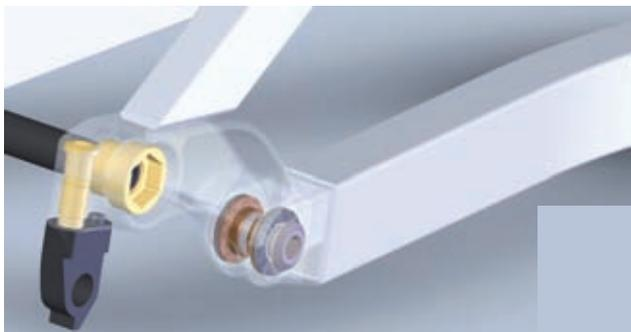
Hier ersetzen igus®-Kunststoffgleitlager die klassischen Wälzlager und trotzen den Umwelteinflüssen wie Schmutz und Korrosion. Durch ihr geringes Gewicht und ihren günstigen Preis haben sie in der Fahrrad-Rahmenkonstruktion auch beim Einsatz im Gelände den entscheidenden technischen Vorteil. Die (noch) nicht weit verbreitete Lösung mit Kunststoff-Lagern ist für den Hersteller außerdem ein Verkaufsargument, da viele Kunden sich von außergewöhnlichen Lösungen begeistern lassen.
