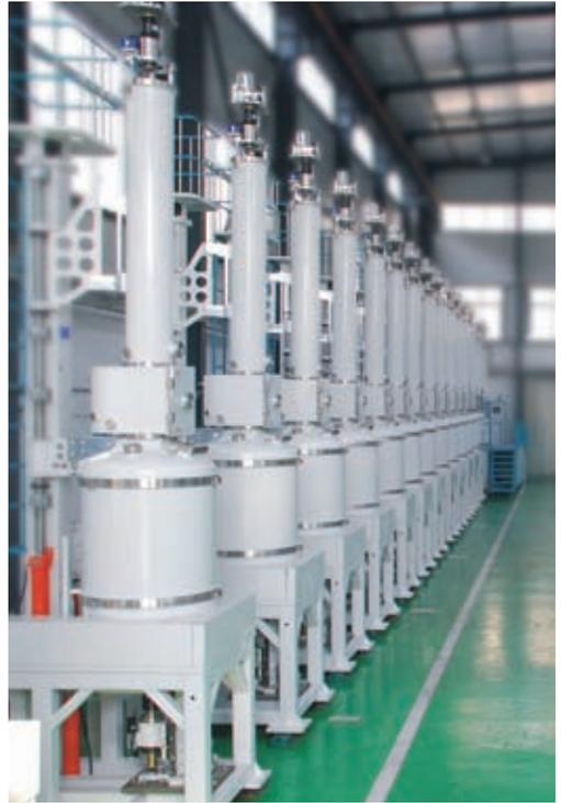
Silizium ist einer der Grundstoffe für Solaranlagen. In dieser Anlage wird es zu Solar-Silizium verarbeitet. Bislang wurden metallische Lager und Linearführungen verwendet, die schnell rosteten und daher häufige Wartung erforderten. Mit dem Umstieg auf igus®-Produkte konnte die Standzeit deutlich erhöht werden. Zum Einsatz kommen iglidur®-Gleitlager und -Anlaufscheiben, igubal®-Stehlager, DryLin® N-Linearführungen sowie die Lineareinheit EasyTube.
