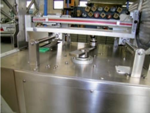
Bei dieser Anwendung wird Salami in Scheiben geschnitten. Wie bei allen Anwendungen mit Kontakt zu Lebensmitteln dürfen auch hier keine Schmiermittel verwendet werden. Die Edelstahlwellen, auf denen der Schlitten verfährt, sind mit iglidur® J-Flanschlagern versehen. Im Antriebshebel kommen igubal®-Gelenklager EGLM zum Einsatz, die leicht und einfach zu montieren sind. Das war besonders wichtig, da sie an nur schwer zugänglichen Stellen verbaut sind.
