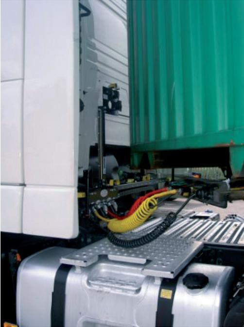
Diese Anwendung ermöglicht es, an Zugmaschinen Auflieger mit verschiedenen Längen anzuhängen. Die Leitungen, mit denen Zugmaschine und Auflieger verbunden werden, müssen flexibel sein, um die unterschiedlichen Längen der Auflieger auszugleichen. Eine platzsparende Lösung bietet hier eine Kombination aus DryLin® W-Schienen und DryLin® R-Gleitlagern. Ohne Werkzeug kann so der Fahrer die Leitungszuführung einfach anpassen.
