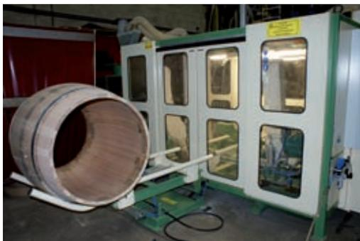
In dieser Maschine werden die Kopfteile für große Weinfässer aus Holz geschliffen. Für die Positionierung der Schleifköpfe kommen DryLin® T-Schienenführungen zum Einsatz. Die Bewegung der Bürsten und der Schiebetüren wird mit DryLin® W-Profilführungen gelagert. Weitere Schwenkbewegungen werden mit Flanschlagern aus iglidur® G realisiert. Alle verwendeten igus®-Produkte sind wartungsfrei, so dass die Maschine eine hohe Standzeit aufweisen kann.
