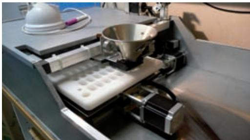
Mit dieser Maschine werden Medikamente aus den Originalverpackungen entnommen und anschließend in kleineren Dosierungen neu verpackt. Das geschieht in einem Arbeitsgang, somit werden 30% bis 50% der benötigten Zeit eingespart. Durch den Kontakt mit unverpackten Tabletten ist absolute Schmiermittelfreiheit erforderlich. Daher werden die Verpackungen mit Hilfe eines DryLin® SLW-Kreuztischs bewegt.
