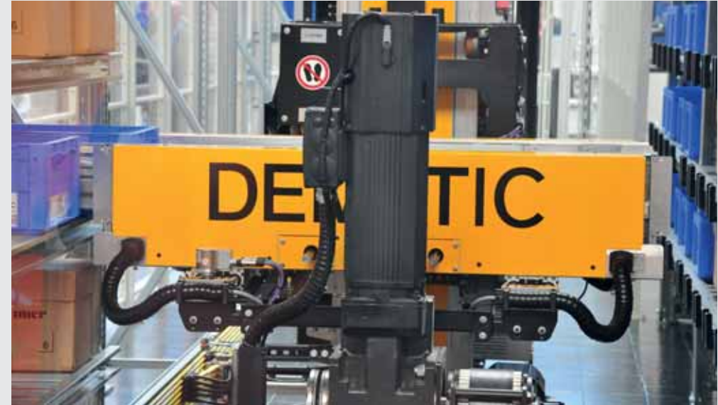
triflex® R im Regalbediengerät
