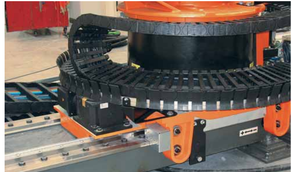
twisterchain® Anwendung an 7. Roboterachse
