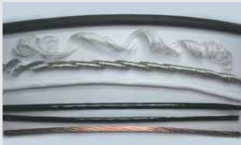
Die CF ROBOT zeigt keinerlei Beschädigung nach über 3 Mio. Bewegungen
