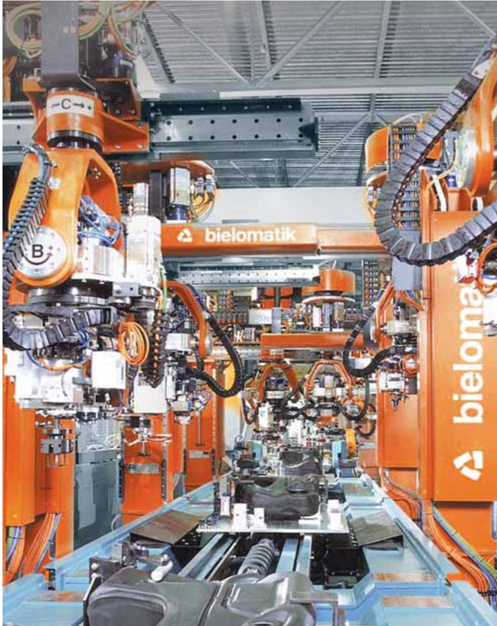
easy triflex® und E2 medium e-ketten® in einer Fertigungsstraße
