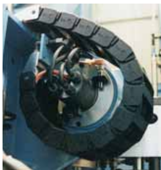
Drehbewegung auf einer igus® Standard e-kette*
