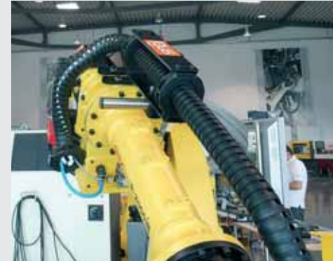
triflex® R an einem Roboterarm
