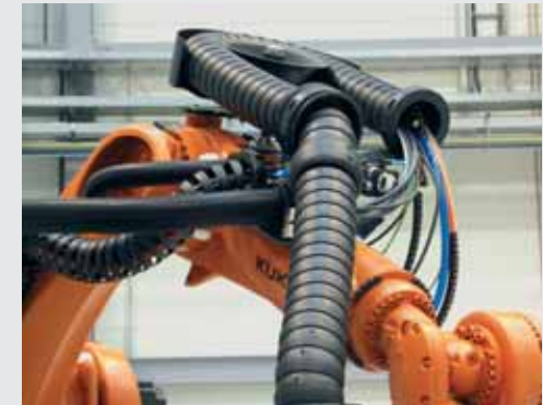
Führung eng am Roboterarm ohne Schlaufenbildung
