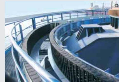
System E4 "RBR" versorgt Hafenkran mit Energie - Drehbewegungen
