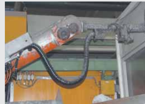
triflex® R in einer Magnesium-Druckgießerei - Ausfallsicher trotz Hitze, Schmutz, Öl und Späne
