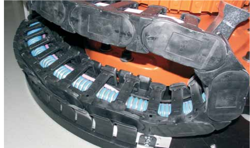
Anwendung twisterchain® an einem Reinigungsroboter
