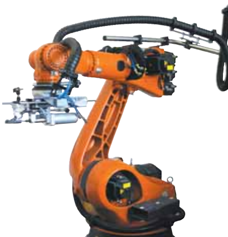
Integrierte Federstäbe verhindern Schlaufenbildung
