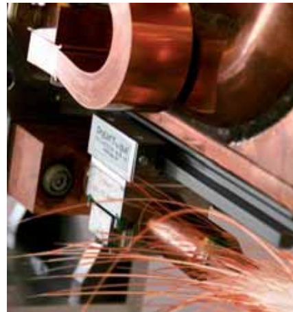
Schweißzange am Roboterkopf mit igus® drylin® T
