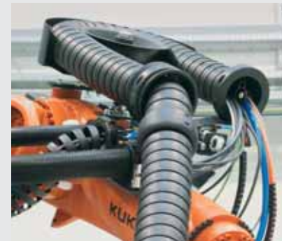
Pneumatisches Rückholssystem triflex® RSP - verhindert Schlaufenbildung am Roboter
