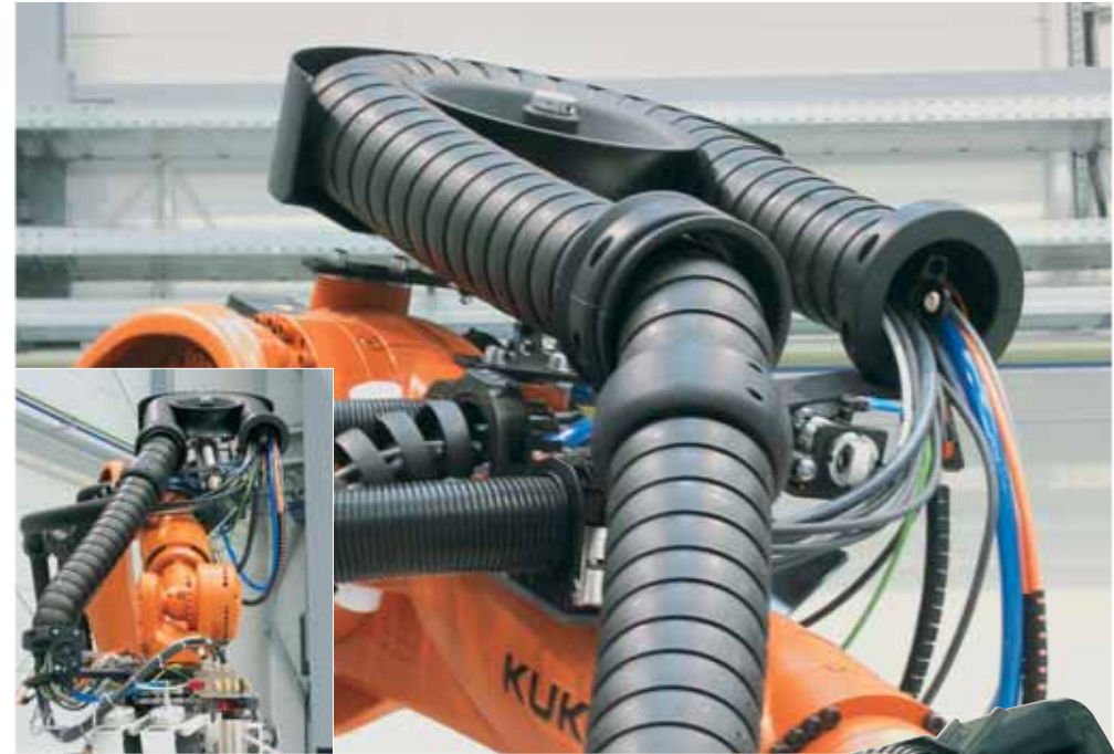
Pneumatisches Rückholssystem triflex® RSP - verhindert Schlaufenbildung im Arbeitsbereich des Roboters
