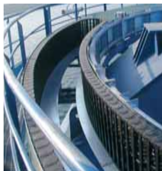
RBR-Drehbewegung mit dem System E4 an einem Hafenkran
