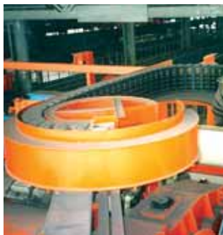
Drehbewegung von 180° mit Standard e-kette* an einem Kran-Drehantrieb
