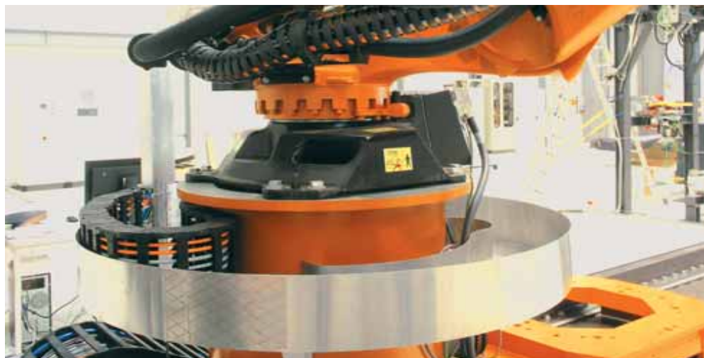
igus® e-kette* mit RBR für 360° Drehbewegung an einem Roboter
