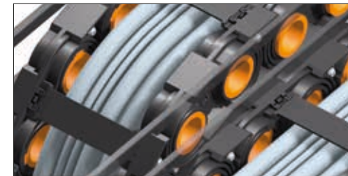
Locking pins retract when the chain links rotate to enter the radius, releasing them from the guide Bolzen fahren ein, wenn sich die Kette in den Radius „biegt“ und lösen die Kette von der Profilführung
