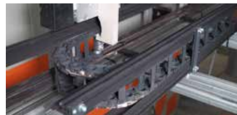
lokchain prototype in a fatigue test in the igus® laboratory lokchain als Prototyp im Dauertestversuch im igus® Labor
