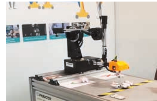
Measuring machine with RL-DQ-RBT-5532S and CPR control system for sorting good from bad parts Messemaschine mit RL-DQ-RBT-5532S und CPR-Steuerung als zur Sortierung von Gut- und Schlechtteilen (PROFACTOR GmbH)
